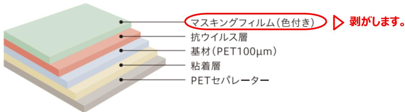
剥がしにくい場合は、マスキングフィルムの端にセロテープなどを貼り付け引っ張ると、簡単に剥がせます。
