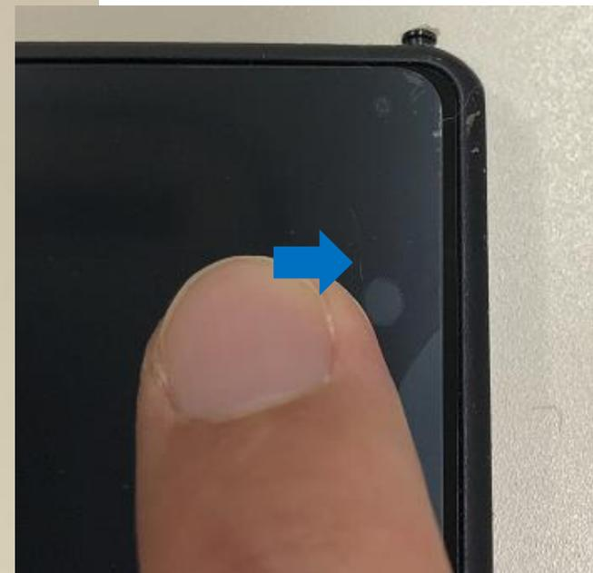
指の腹でフィルムの端に気泡を押し出します。
