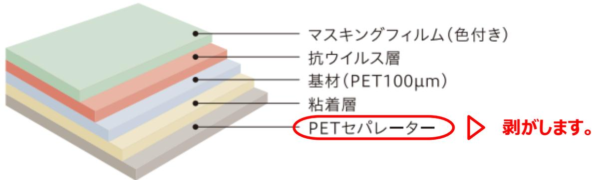
PETセパレーターは、最初に剥がしやすいようにシートの4辺を大きめに残してカットしています。
